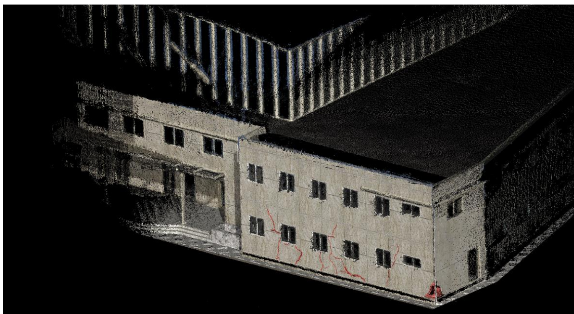
图 24：局部裂缝的三维重建
